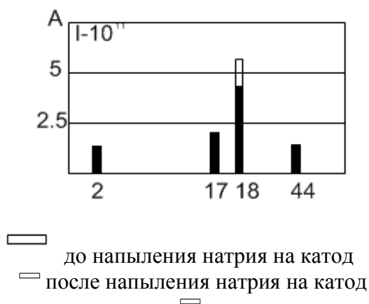
Рисунок 2. – Спектр остаточных газов в системе.
