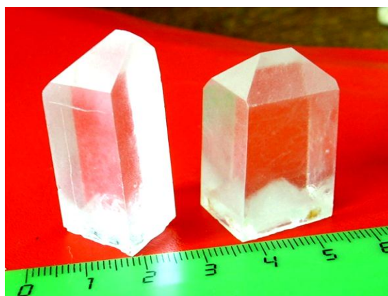
Рис. 3. Фотография кристаллов ADP, выращенных статическим методом при концентрационной конвекции раствора
