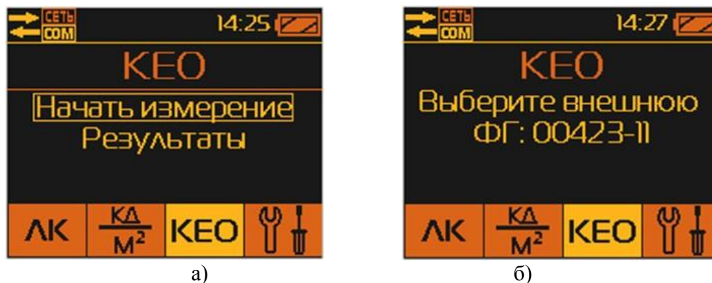
Рис. 3. Интерфейс дисплея: а) запуск измерений КЕО, б) выбор внешней фотоголовки
