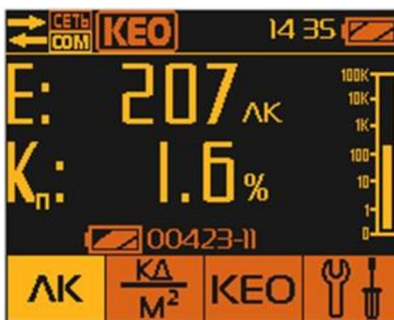
Рис. 5. Измерение освещенности с помощью внутренней фотоголовки
