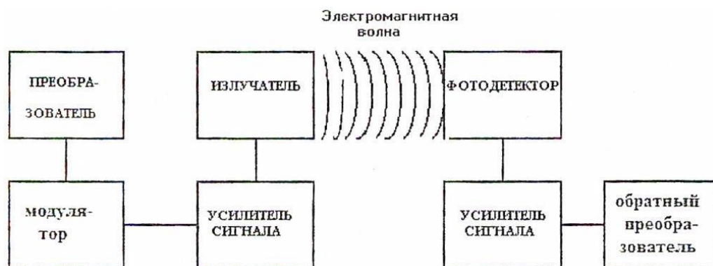
Рис. 1. Структурная схема беспроводной оптической связи
