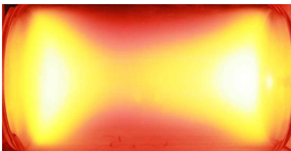
Рис. 1. Внешний вид свечения ВЧЕР. Ne , p = 0.5 Тор, f = 6 МГц, V_{\sim} = 2.1 кВ.
