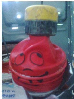
Рис. 6. Поршень вытеснительной камеры (мембрана)
