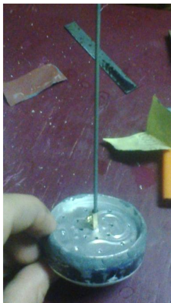
Рис. 5. Поршень рабочего цилиндра
