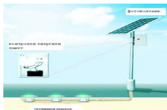
Рис. 3. Способ крепления мигающих светильников в асфальте по пешеходной дорожке
