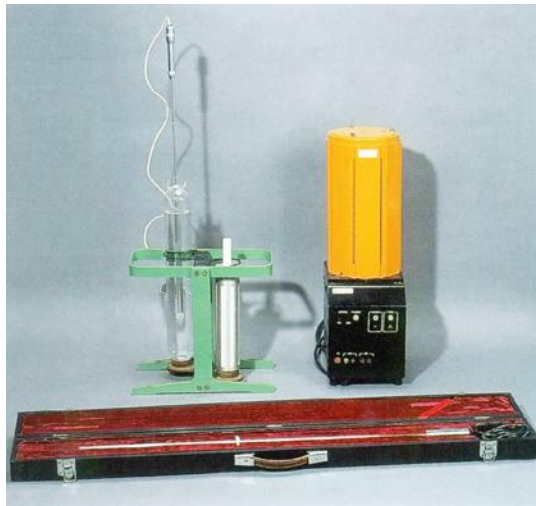
Рис. 1. Ампула тройной точки воды, аппаратура для реализации температуры плавления галлия, платиновый термометр сопротивления – интерполяционный прибор МТШ-90 в составе Государственного первичного эталона единицы температуры – Кельвина
