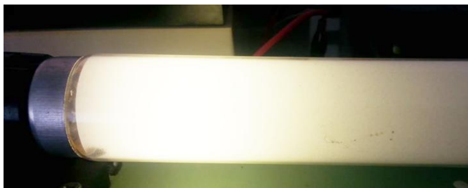
Рис. 2. Околоэлектродное свечение люминофора в люминесцентной лампе
