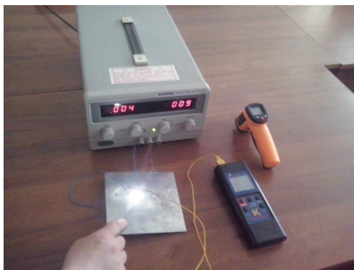
Рис. 1. Установка для изучения термочувствительности кожи человека
