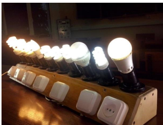
Рис. 1. Установка для экспресс-оценки цветовой температуры
