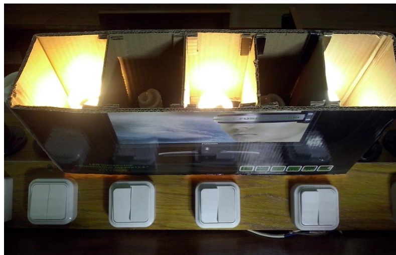
Рис. 2. Внешний вид измерительной линейки установки со светоограничительным устройством
